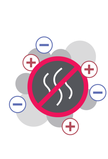
Pachové plyny a aerosóly oxidujú pri kontakte s iónmi kyslíka a sú neutralizované
